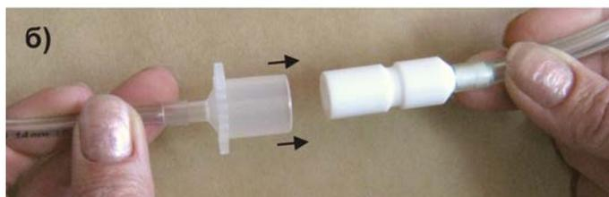
Рис.9. Установка на коннектор наконечников:
