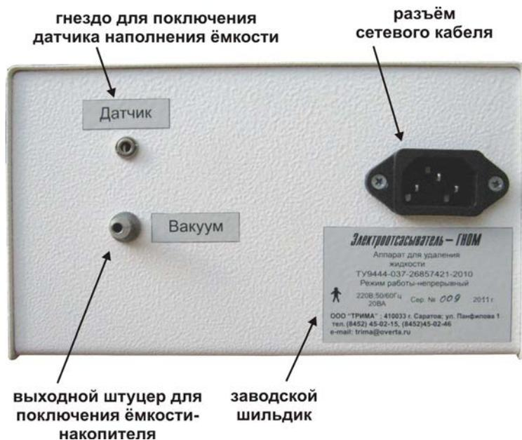
Рис.5. Задняя панель электронного блока.
